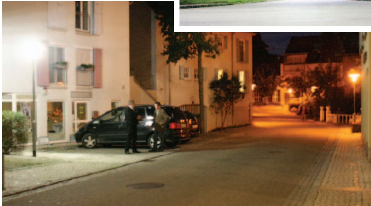
Selbst mit kurzen Masten bei großen Mastabständen lässt sich durch geschickte Linsenführung ein optimales Ergebnis ohne Dunkelfelder erreichen.
